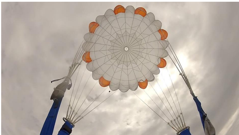
Figur 8. Vores hovedskærm fuldt udfoldet efter at linen er blevet klippet over. I bunden af skærmen kan man lige ane den ene af de to bokse der indeholder timer og klippemekanismen. Foto: Ahmad Rahman
