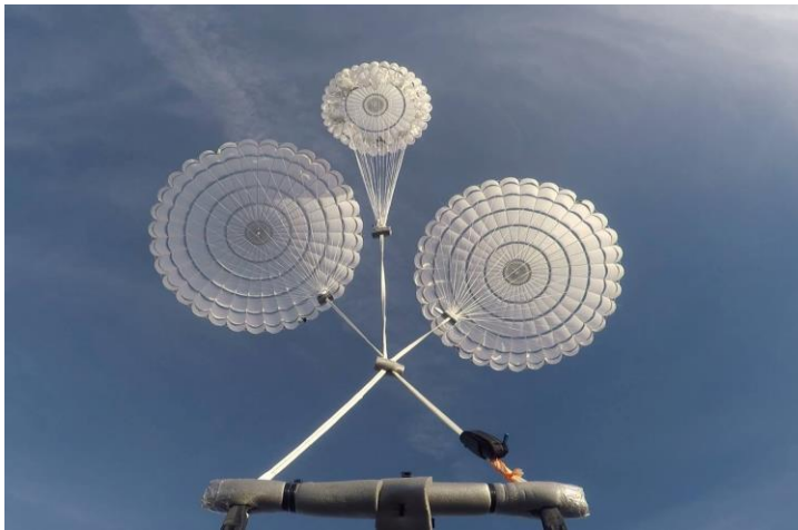
Figur 14. Setup til spring med tre faldskærme. T-rex-bidsel i bunden, under hvilken de to risers går til springeren. Over bidslet føres to risers til en sjækel hvor de tre faldskærme mødes.
