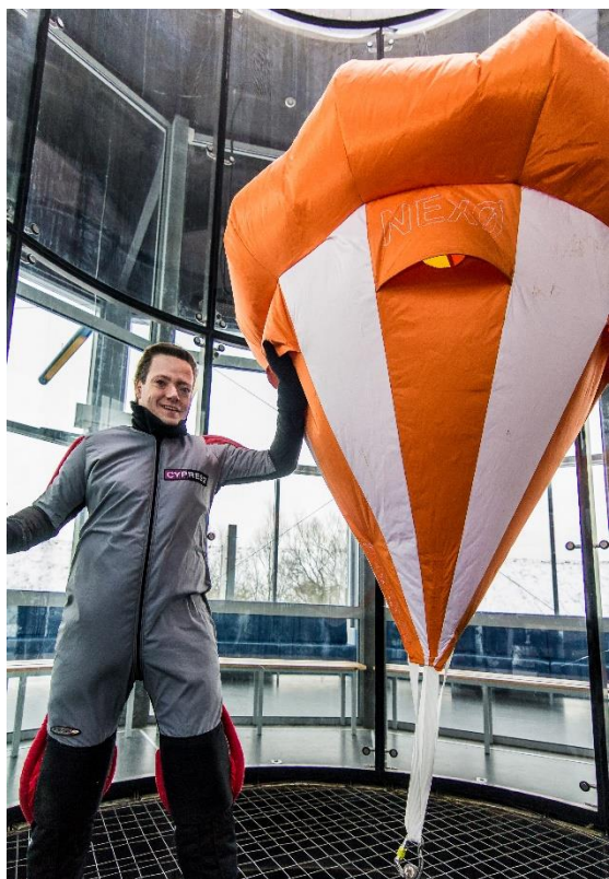
Figur 3. Balluten til Nexø I som den endte med at tage sig ud hos Copenhagen Air Experience. Foto: Jev Olsen.
