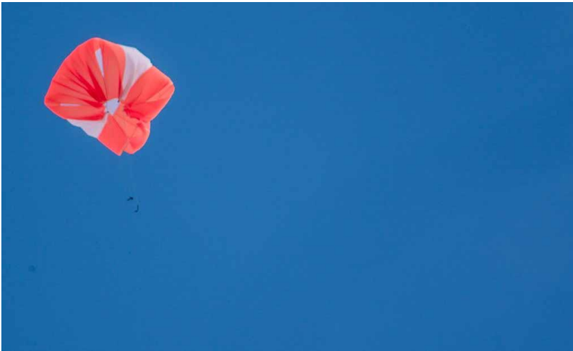
Figur 11. Reefing er ikke nemt i praksis. Her er skærmen forladt efter at den nægtede at folde sig ud
