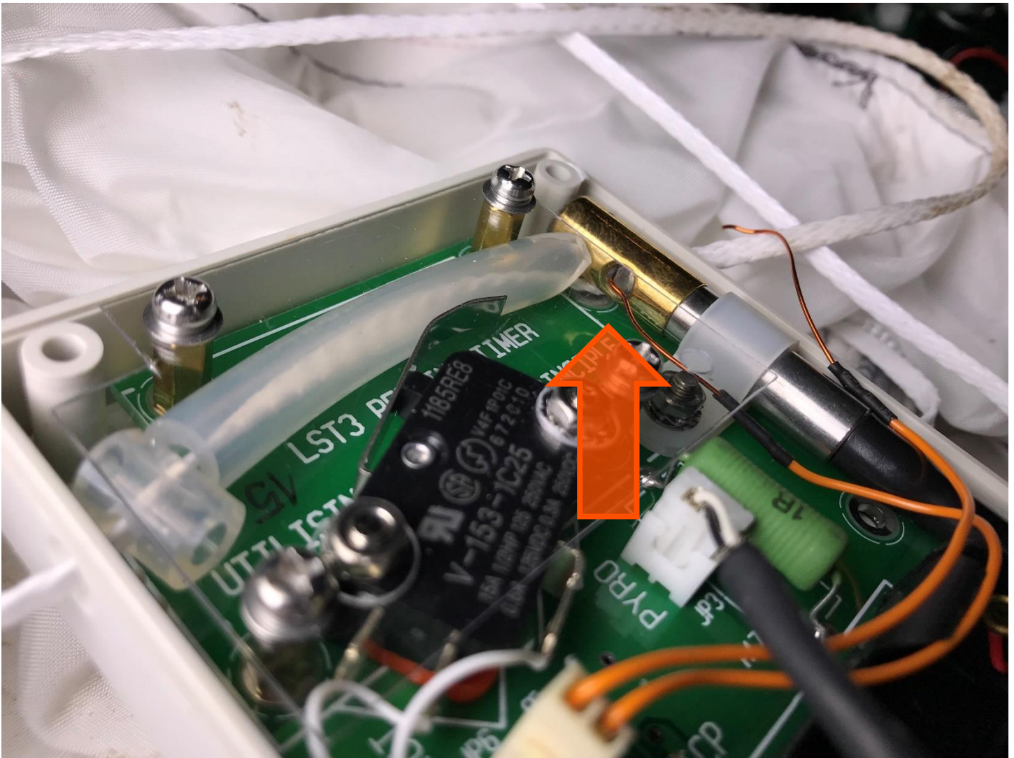
Figur 16. reefingsnoren var ikke ført igennem cutteren, og blev derfor ikke klippet over
