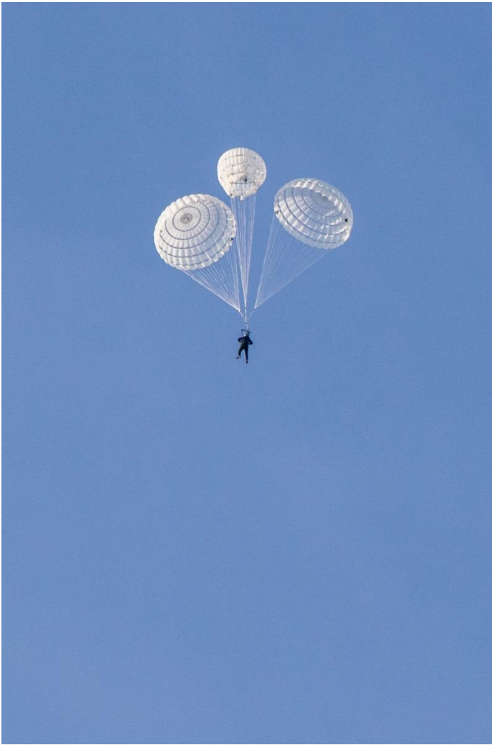
Figur 15. To faldskærme blev perfekt bærende, og én forblev i første trin af reefingprocessen
