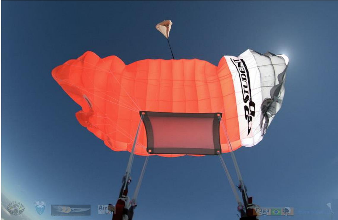
Billede 4. Slideren kommer ikke ud
