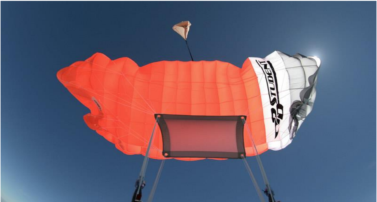
Billede 1. En bærende skræm som ikke er foldet helt ud
